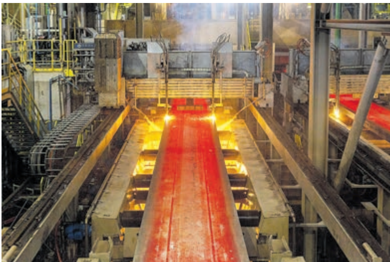
De plakken staal die een continugietmachine produceert zijn 8 tot 12 meter lang en 22,5 cm dik. Foto: aangeleverd
