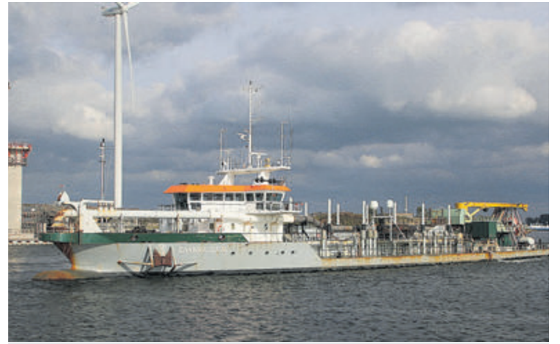
De hopperzuiger Charlock, bezig met het uitdiepen van het kanaal aan de binnenzijde van de zoutdam. Foto: Erik Baalbergen
