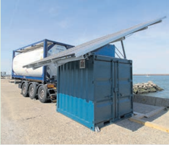
De mobiele drinkwaterfabriek van SEA Water op de zuidpier. Foto: Erik Baalbergen
