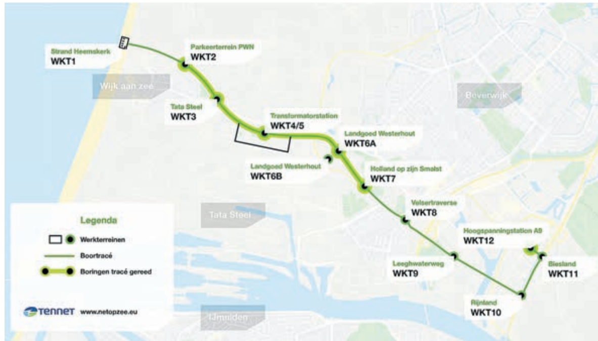
Een overzicht van alle 12 werkterreinen voor het aanleggen van de kabels voor het aansluiten van de windparken op zee op het landelijke hoogspanningsnet. Illustratie: aangeleverd
