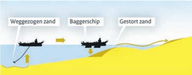
Het baggerschip haalt enkele kilometers uit zee zand naar boven en brengt dit tot circa een paar honderd meter voor de kustlijn (de vooroever). Hier wordt het uitgestort en uitgespoten over het water. Afbeelding: Rijkswaterstaat
