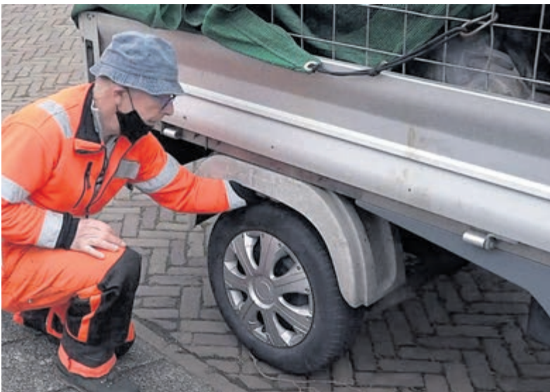
Het wiel loopt aan de binnenzijde tegen het chassis aan. Bron: NH Nieuws
